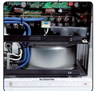
Schwermetall: Spätestens der Vergleich mit dem Maßstab zeigt die majestätische Größe des Netzteils. Gleich zwei davon behausen eine Endstufe.
